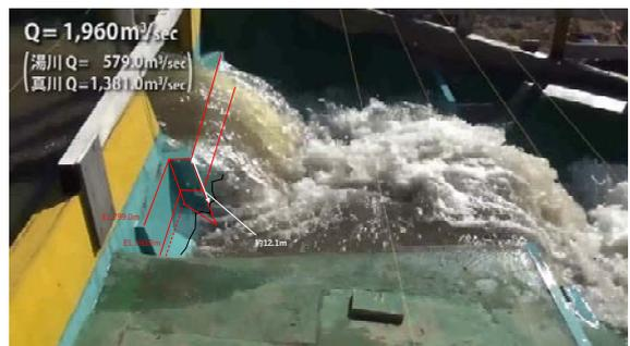
図2 水面-構造物境界と水通し天端の比高差12.1m (計画流量:  $1,960\text{ m}^3/\text{s}$ )
