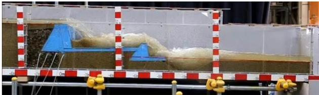
図3 本副間の流況と水面形成状況 (Q=1,960m<sup>3</sup>/s)
