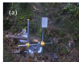
写真-2 地層境界付近からの湧水 (a)常時 (b) 豪雨時 (2017/10/23)
