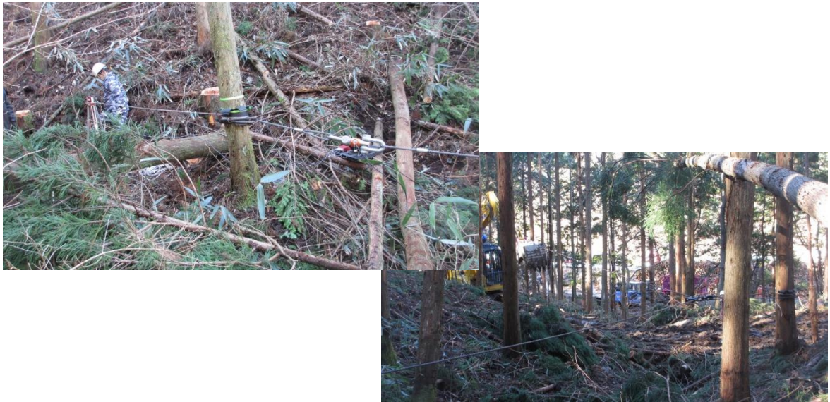
写真1 スギの引き倒し現地実験の様子. 供試木の 1.1m 高さにワイヤーを掛け重機で牽引
