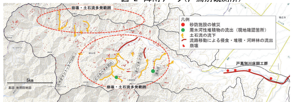
図-3 平成 28 年 8 月豪雨による戸蔭別川流域の土砂移動実態
