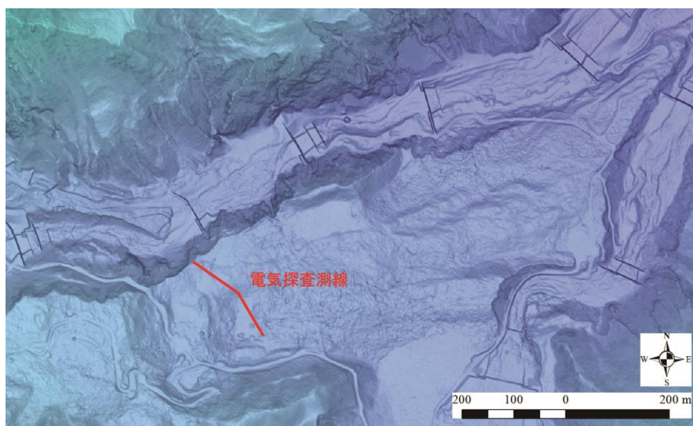
図-2 電気探査測線位置図(岩石なだれ堆積物上流部)
