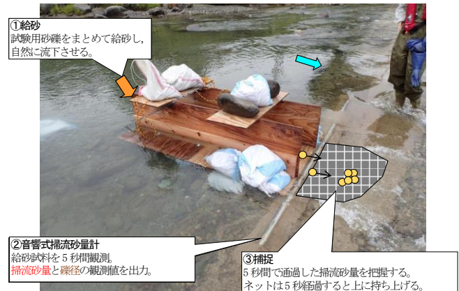
図-1 簡易水路設置状況
