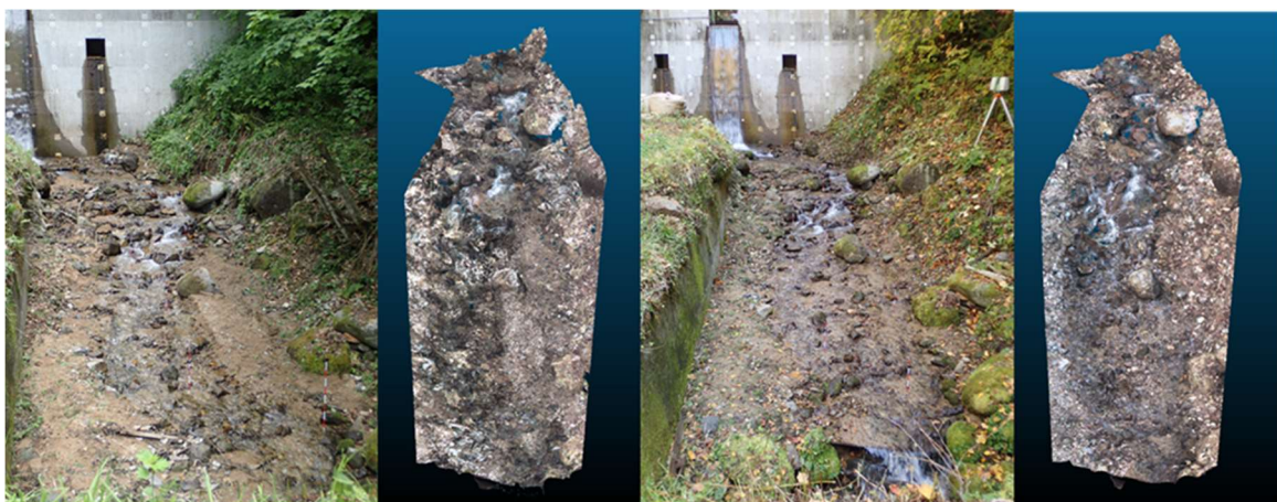
図 1. 対象地の計測時の写真(下流側から撮影)と合成したレーザデータ 6 月計測(左)と 10 月計測(右)。レーザ点群は RGB 情報を付与して表示している。
