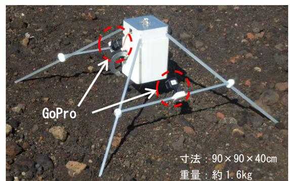
図 2：改良型表面流確認デバイス
