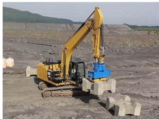
写真 1 センターホール挿入型把持部による試験状況
