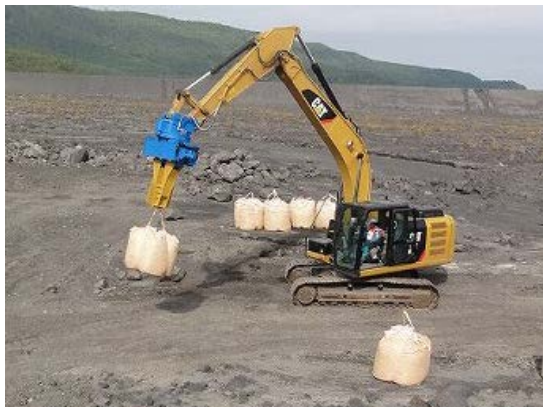
写真 2 グラップル型把持部による試験状況
