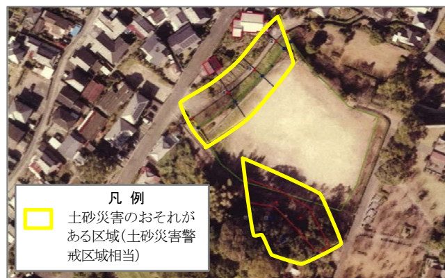
図 1 土砂災害のおそれがある応急仮設住宅建設候補地の例（熊本県提供資料に加筆）
