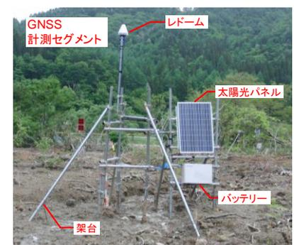
図 4 GNSS 計測セグメントの構成
