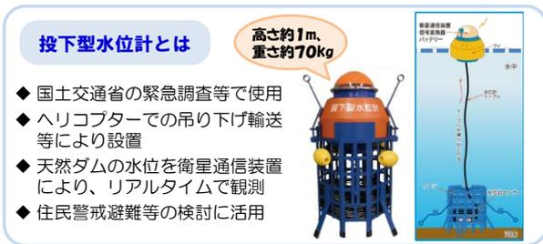
図1 投下型水位計の概要
