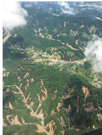
写真 1 九州北部豪雨で発生した無数の表層崩壊 下から奈良ヶ谷川・その上は北川右支・本流、いずれも朝倉市。(2017 年 7 月 9 日海堀撮影)
