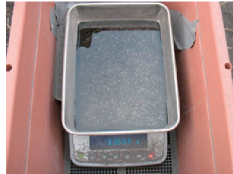
図 5 電子天秤による詳細降灰量観測状況
