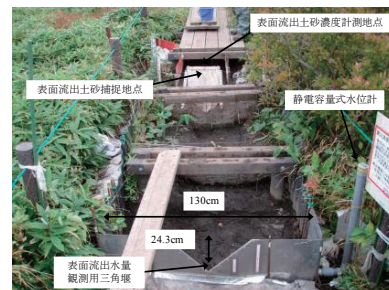
図-1 表面流出水量の観測装置の概要
