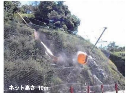
写真-3 衝突誘導性能確認実験（高知）
