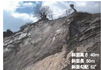
写真-4 誘導性能確認実験（スイス）
