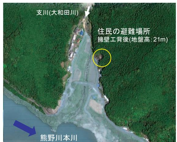
図-2 浅里和田集落での土石流突入直前の本川水位高分布状況 水位高18.11m(9月4日午前2時)相賀水位観測所データ(国土交通省近畿地方整備局紀南河川国道事務所)
