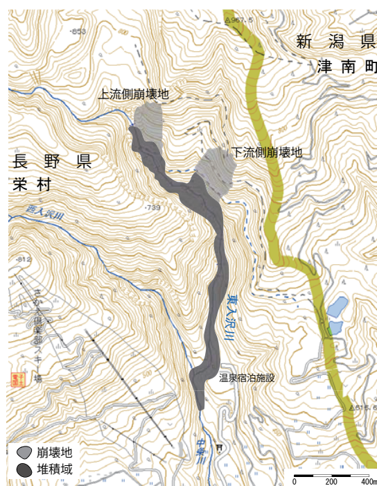
図－2 地震によって発生した東入沢川沿いの崩壊・堆積域の分布（電子国土地図に加筆）
