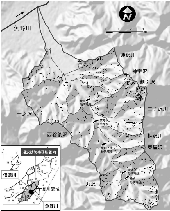
図-1 登川流域内の崩壊発生状況
