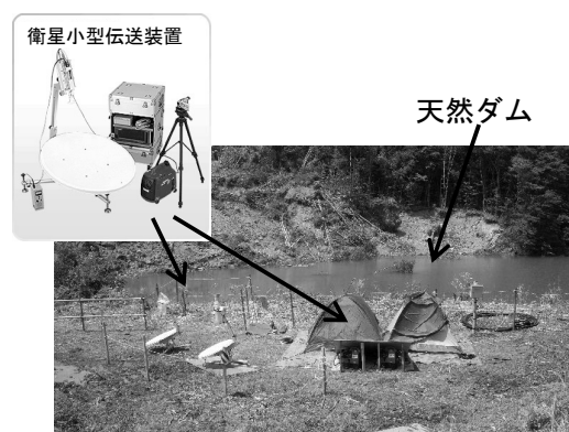
図-1 岩手・宮城内陸地震時の衛星小型画像伝送装置 (Ku-SAT) 観測状況
