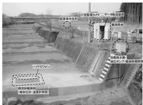
写真-1 大沢川における掃流砂観測施設の概要
