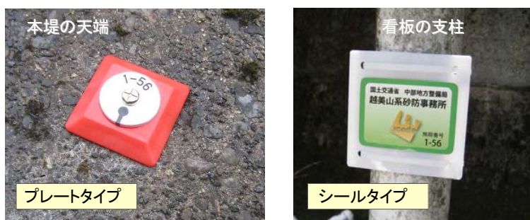
図 3 IC タグの構成と設置写真
