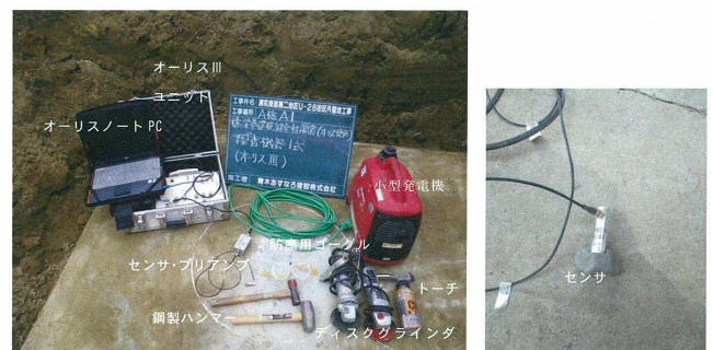
写真1 高周波衝撃弾性波探査装置
