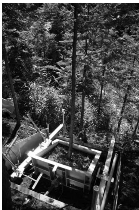
写真－1 根系を含む供試体に対する現地大型せん断試験の実施状況
