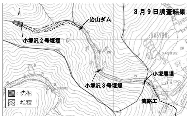
図 3 水抜き暗渠からの土砂流出状況概要図
