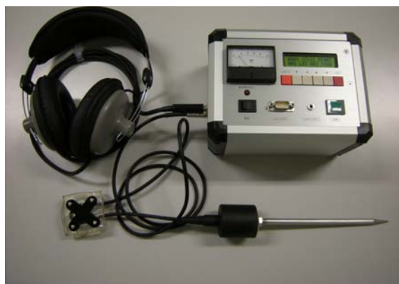
写真 1 普及型地下流水音装置
