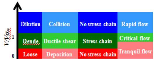
図-11 流速と長波速度による流れの状態
