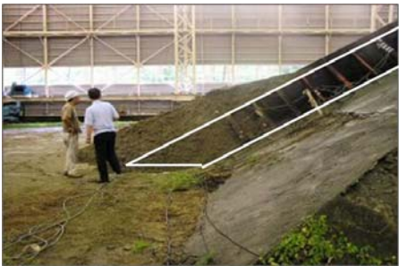
写真－2 崩壊後の実験斜面(側面)
