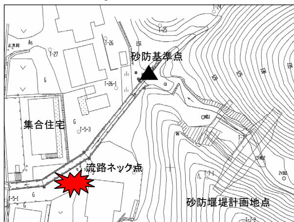
図-4 A地区の砂防堰堤配置と下流流路の状況
