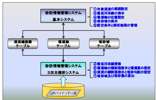
図-2 3次元解析システムのシステム構成
