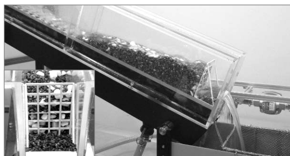
図3 格子型堰堤の施設効果
