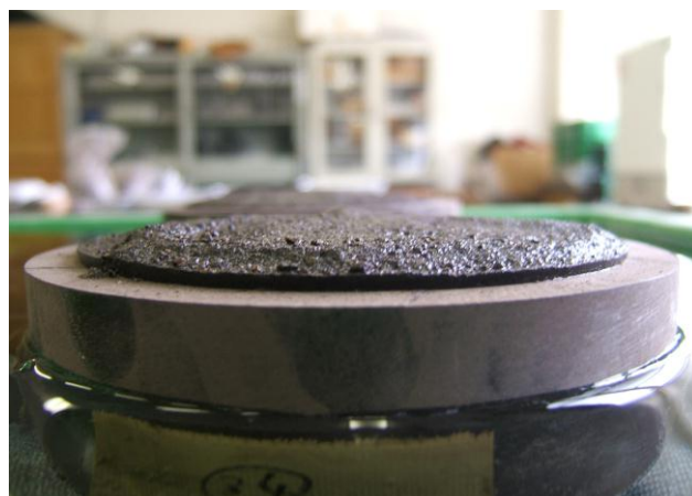
写真2 吸水後24時間経過後の試料(飽和度114.2%) 試料が膨張し、容器からはみ出ている
