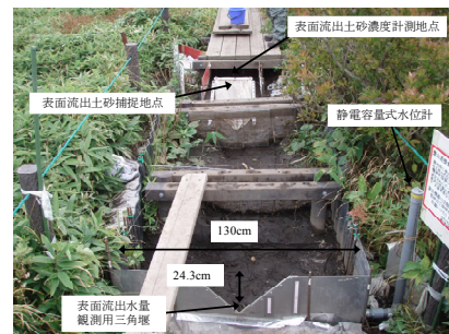
図-1 表面流出水量の観測装置の概要
