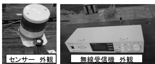
図-1 開発した斜面崩壊検知センサーと無線受信機
