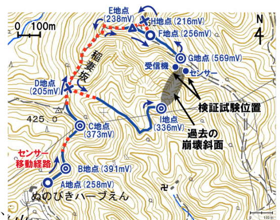
図－3 無線伝送試験位置と電波強度結果
