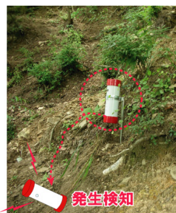
図-1 崩壊検知センサー外観 および動作イメージ
