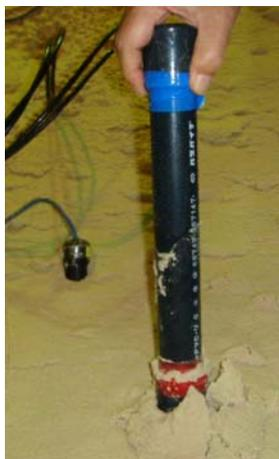
無線傾斜計は崩壊斜面の下にいる救護者を保護するため、臨時に設置する警報機を初期の目的としていたので、30cmぐらいの深さに埋設する。危険な斜面では露出している岩や樹木に固定して退避するような設置法を想定している。
