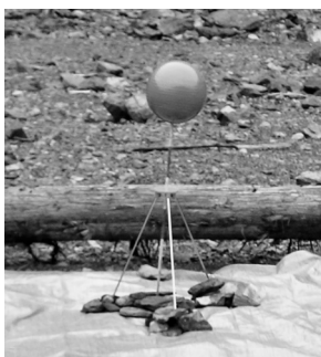
参照点の 10cm 球形反射体と測定データ点群
