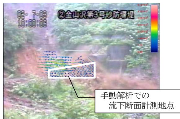
図5 浦川での流下断面の誤検知の例
