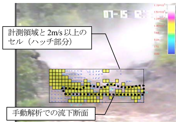
図4 焼岳での流下断面検知の例
