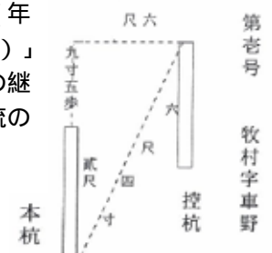
図 - 1 砂量標杭の建方
