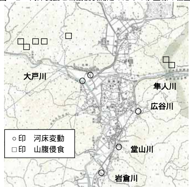
図 - 2 河床変動と山腹侵食測定のための砂量標の位置
