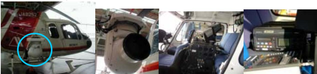
図 2-1 ヘリコプター搭載型ハイビジョン撮影装置（左から：防振装置とヘリコプター水色の部分が防振装置、防振装置、機内に設置された撮影装置、収録 VTR 装置）
