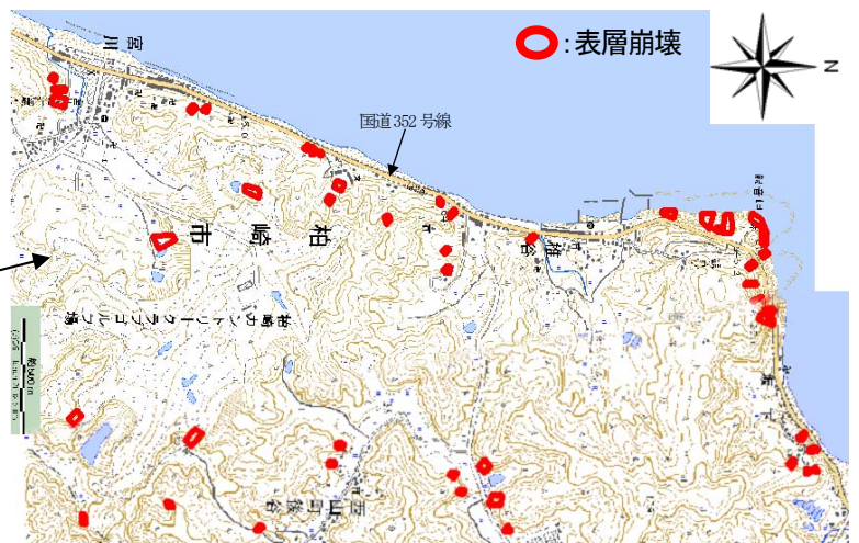
図-2 2007 年新潟県中越沖地震による柏崎市西山町周辺の斜面崩壊分布図 (国土地理院 25000 分の 1・地形図「宮川」の一部に加筆)
