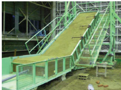
図 1 30° 斜面模型実験装置全景 (試験前と試験後)
