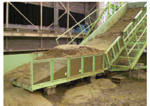
図 1 30° 斜面模型実験装置全景 (試験前と試験後)
