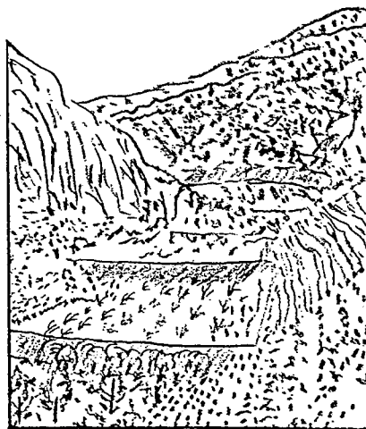
図7 群状谷止工(土谷止工, 淤地谷止工)
