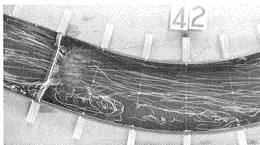
写真-5 垂直ステレオ写真による流跡の立体像の一例. この写真では時間を刻むストロボ照射は していないが, 粒子の遅速により明るさの差が出ている. 速度差が大きいとき注意が要る. (ニコンF, レンズ35ミリ, フラッシュ140W10本, f4 1秒露光)
